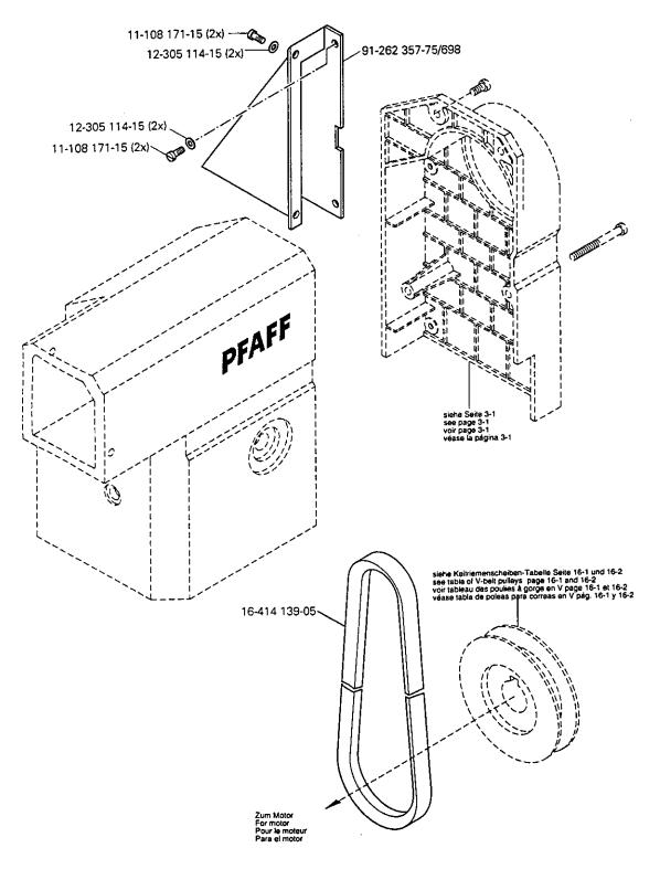
Einbaumotor Built-in motor Moteur incorporé Motor incorporado
